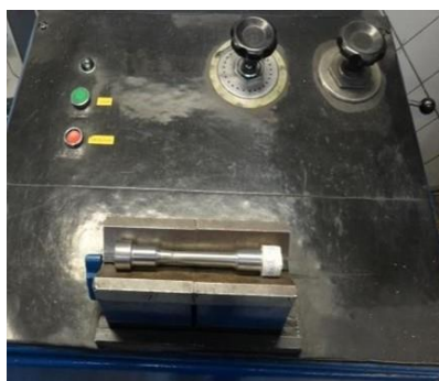
Figura 13 – (a) Preparação do ensaio mecânico de tração e (b) visualização do corpo de prova para o ensaio mecânico de tração.
