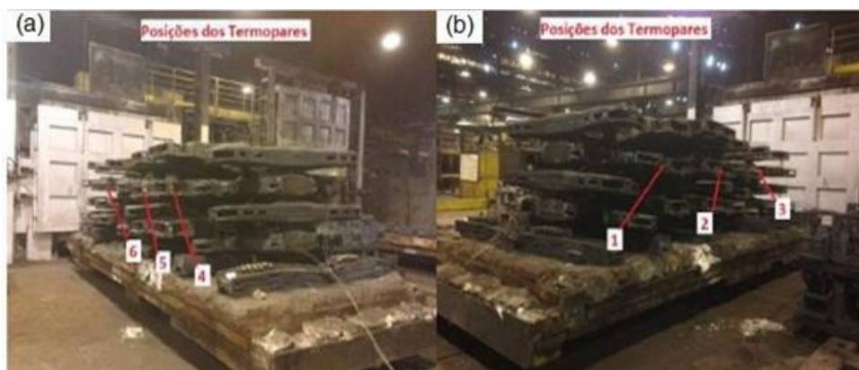
Figura 8 – Posicionamento dos termopares – (a) Lado esquerdo e (b) Lado direito.
