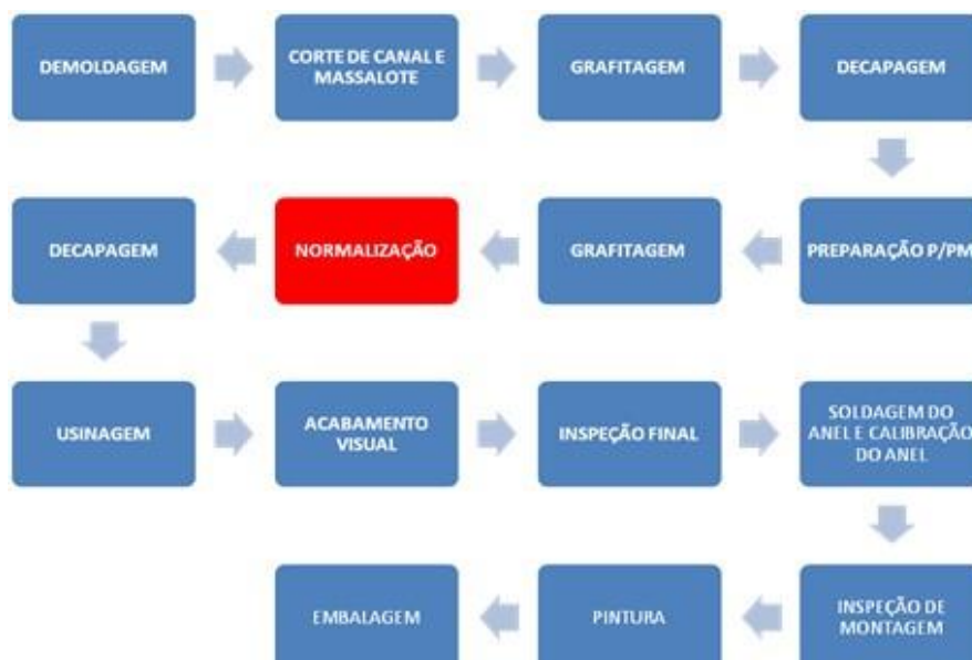
Figura 2 - Processo de fabricação da travessa ferroviária.
