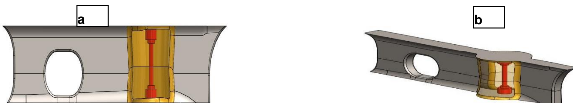
Figura 11 - Vista frontal (a) e diagonal (b) do corpo de prova para ensaios de tração (CDP) no interior da travessa.
