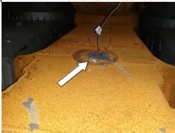
Figura 7 - Local de instalação dos termopares para a realização da medidas da temperatura de tratamento térmico nas travessas.
