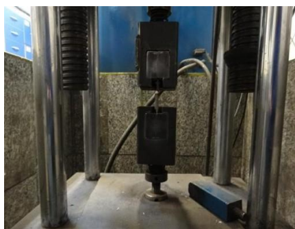
Figura 13 – (a) Preparação do ensaio mecânico de tração e (b) visualização do corpo de prova para o ensaio mecânico de tração.
